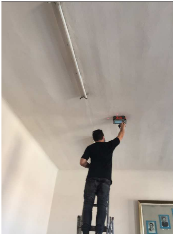
Scanarea profilelor metalice I36 in planseu peste parter
